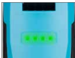
Batteriestatus- und Ladestandanzeige
