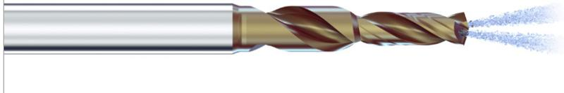
CrazyDrill Coolpilot Titanium ATC wurde entwickelt als Pilot- und Kurzbohrer mit integrierter Fasenschneide für Titanlegierungen im Durchmesserbereich von 1.0 bis 6.35 mm, für Bohrtiefen bis 3 x d. Damit ist er die ideale Ergänzung zu CrazyDrill Cool Titanium ATC. Er ist versehen mit spiralisierten Kühlkanälen in Tropfenform bis an die Schneiden sowie einem Spanbrecher-Nutenprofil. Die neue, kupferrote Beschichtung vermeidet Verkleben und unterstützt den effizienten Bohrprozess.
