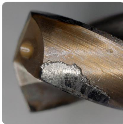
Materialverklebungen an Führungsfasen und den Nebenfleiflächen erhöhen die Schnittkräfte und wirken sich negativ auf die Bohrungsqualität aus.
