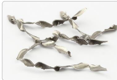
Lange Späne verursachen ein Verklemmen der Späne und erschweren die Späneausfuhr. Dies führt zu Überhitzung und in der Folge zu Aufbauschneiden. Das Ergebnis ist ein Schneidenausbruch in kurzer Zeit.
