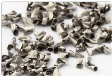
Kompakte, kurze und gekrümmte Späne werden leichter abgeführt und garantieren eine lange Standzeit sowie eine hohe Prozesssicherheit.
